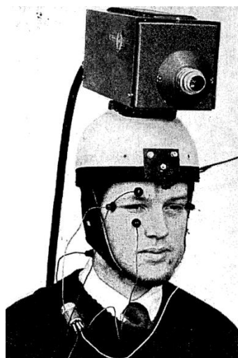
Obr. 2 Eyetracker využívající kameru a EOG (zdroj: https://arxiv.org )
