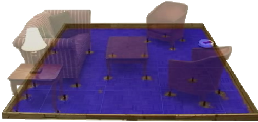
Obrázek 13: Ukázka práce robotického vysavače iRobot Roomba . Modrá část představuje vyčištěnou plochu po ukončení úklidového procesu.
