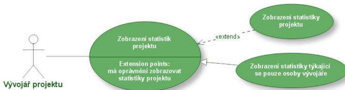
Obr. 3.6, Use Case diagram znázorňující možnosti manažera při zobrazování statistik
