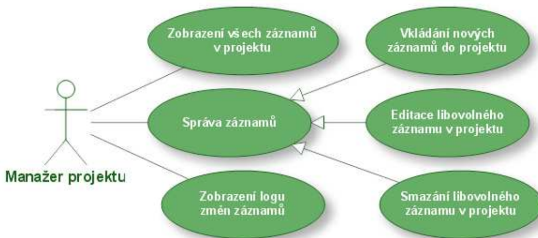
Obr. 3.4, Use Case diagram znázorňující možnosti manažera projektu pro práci se záznamy
