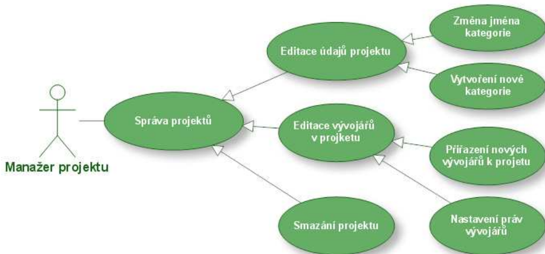
Obr. 3.1, Use Case diagram znázorňující získávání rolí v systému
