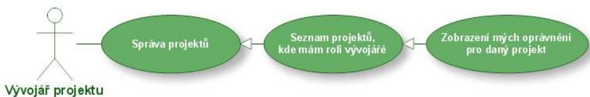
Obr. 3.3, Use Case diagram znázorňující možnosti vývojáře v záložce Správa
