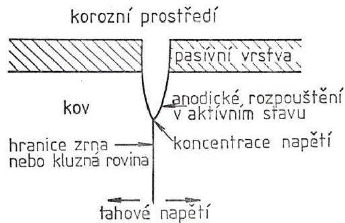
Obr. 19 Korozní praskání kovů [38]
