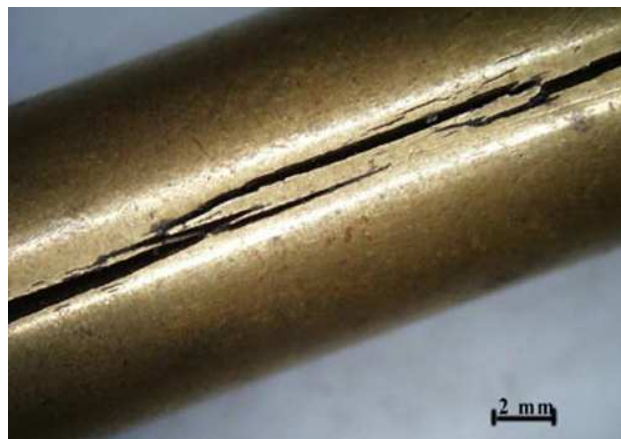
Obr. 20 Mosazná trubka o délce 80 mm, průměru 100 mm a tloušťce stěny 3 mm. Doba expozice 1 rok. [37]
