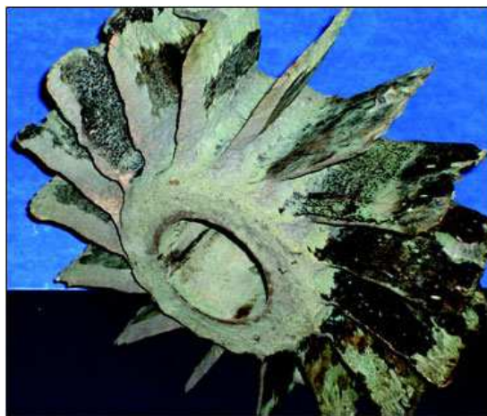
Obr. 13 Měděný rotor napadený korozí ve vodě. [10]
