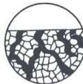
Obr. 30 Schéma interkrystalické koroze [4]
