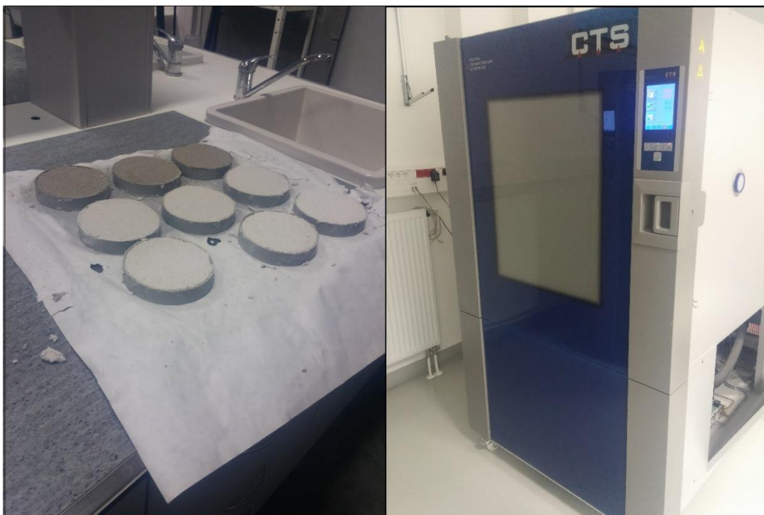
Obr. 20 Zkušební kroužky (vlevo) a klimakomora (vpravo)
