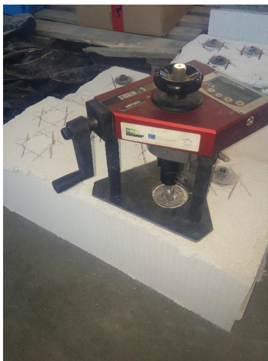
Obr. 23 Přídržnost k podkladu
