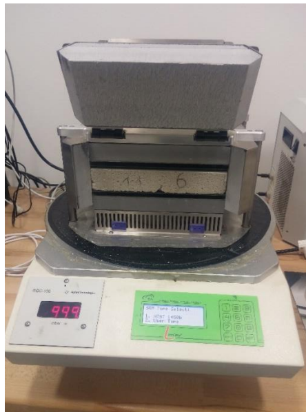
Obr. 19 Příklad přístroje pro měření součinitele tepelné vodivosti
