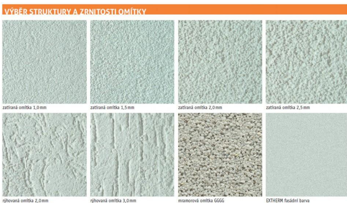
Obr. 12 Příklad struktury a zrnitosti omítek [41]
