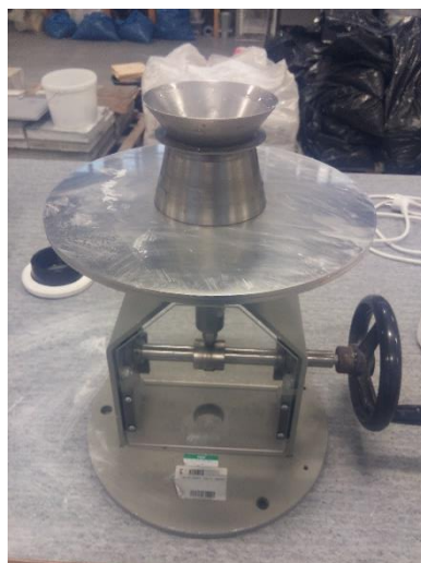
Obr. 16 Stanovení konzistence čerstvé malty pomocí střešovacího stolku
