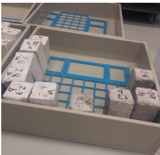
Obr. 22 Měření koeficientu kapilární absorpce
