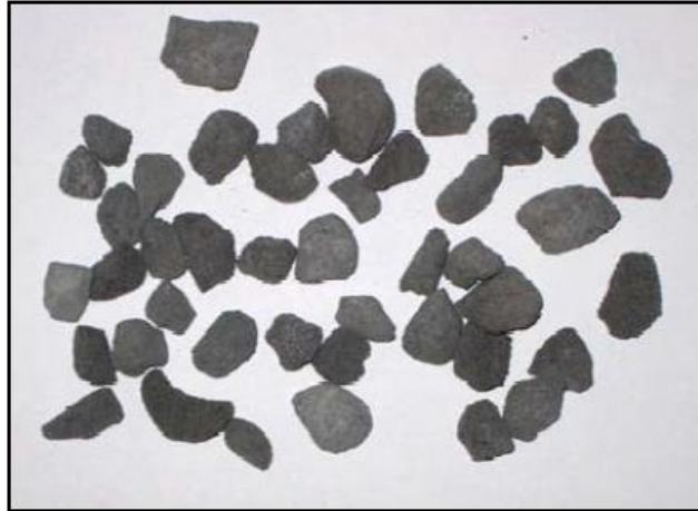
Obr. 3 Kamenivo z pěnového skla [10]
