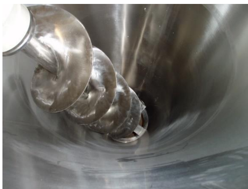
Obr. 14 Homogenizátor sypkých směsí [45]
