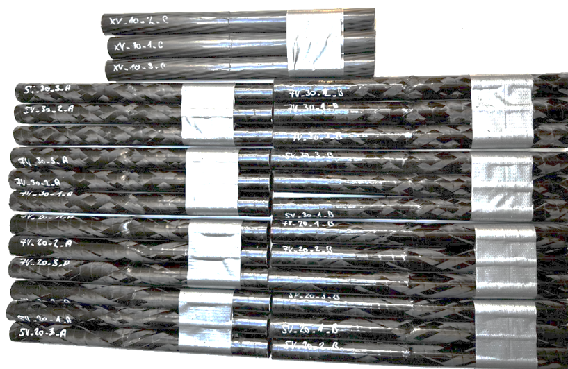
Obrázek 44: Sada vzorků testovaných tříosým ohybovým namáháním (včetně komerční varianty)
