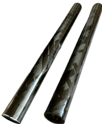
Obrázek 34: Vzorky různých úhlů návinu (vlevo 20°, vpravo 30°)
