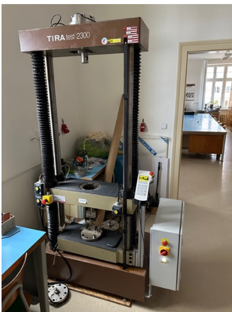
Obrázek 32: Trhací zařízení Tiratest 2300 (ohyb)
