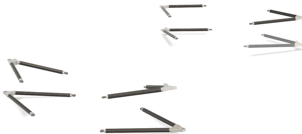
Obrázek 60: 3D vizualizace lichoběžníkového zavěšení využívající kompozitní trubky
