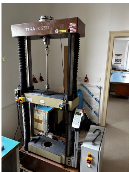
Obrázek 45: Trhací zařízení Tiratest 2300 (tlak)
