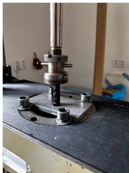
Obrázek 46: Uložení testovaného vzorku (tlak)
