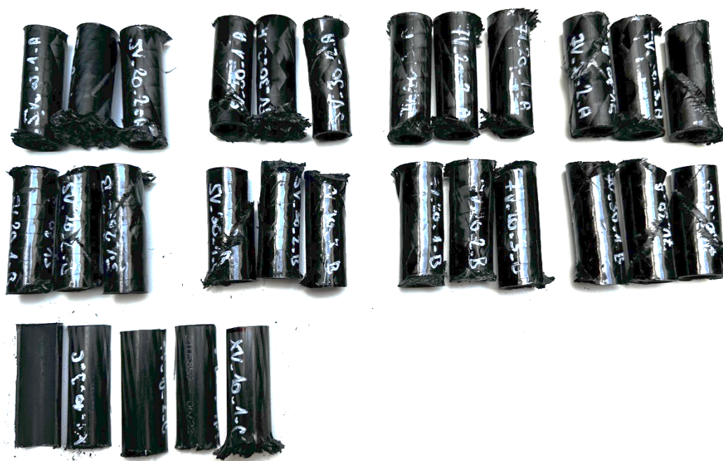
Obrázek 56: Sada vzorků testovaných axiálním tlakovým namáháním (včetně komerční varianty)
