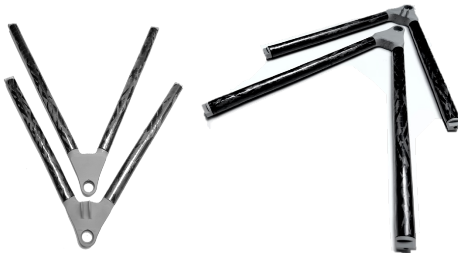
Obrázek 63: Dva pohledy na zhotovené prototypy předních lichoběžníkových ramen s optimálním návinem
