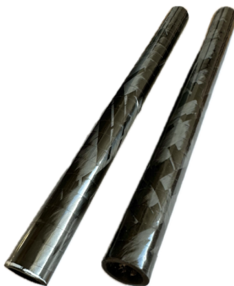
Obrázek 34: Vzorky různých úhlů návínů (vlevo 20°, vpravo 30°)
