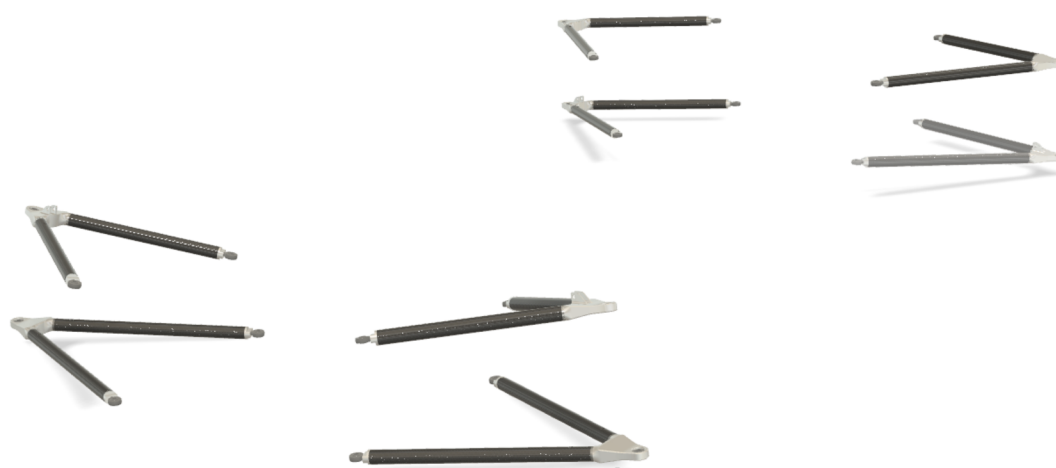
Obrázek 60: 3D vizualizace lichoběžníkového zavěšení využívající kompozitní trubky
