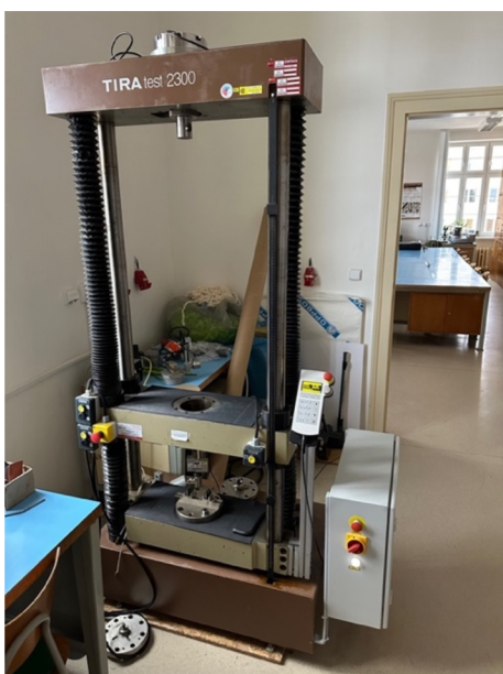
Obrázek 32: Trhací zařízení Tiratest 2300 (ohyb)
