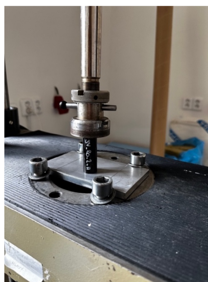
Obrázek 46: Uložení testovaného vzorku (tlak)
