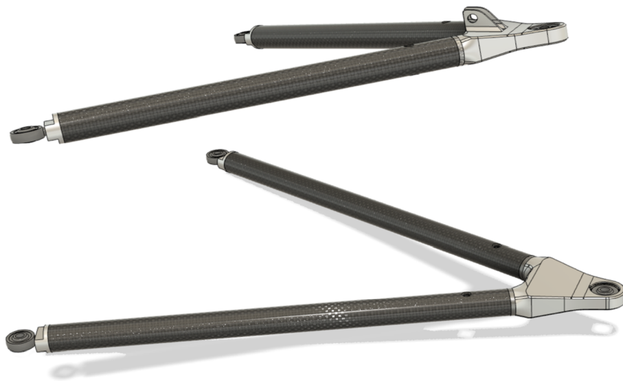
Obrázek 61: 3D vizualizace detailu sestavy ramen levého předního kola monopostu
