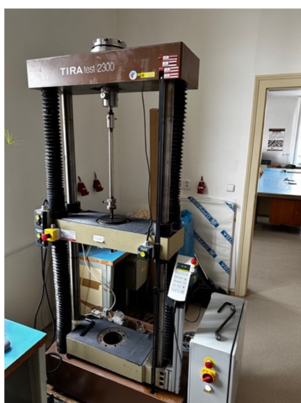
Obrázek 45: Trhací zařízení Tiratest 2300 (tlak)
