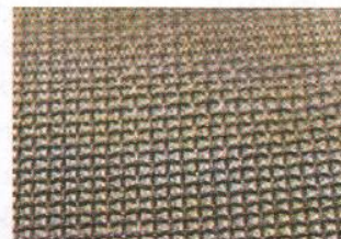
Tkaná geotextília z monofilov
