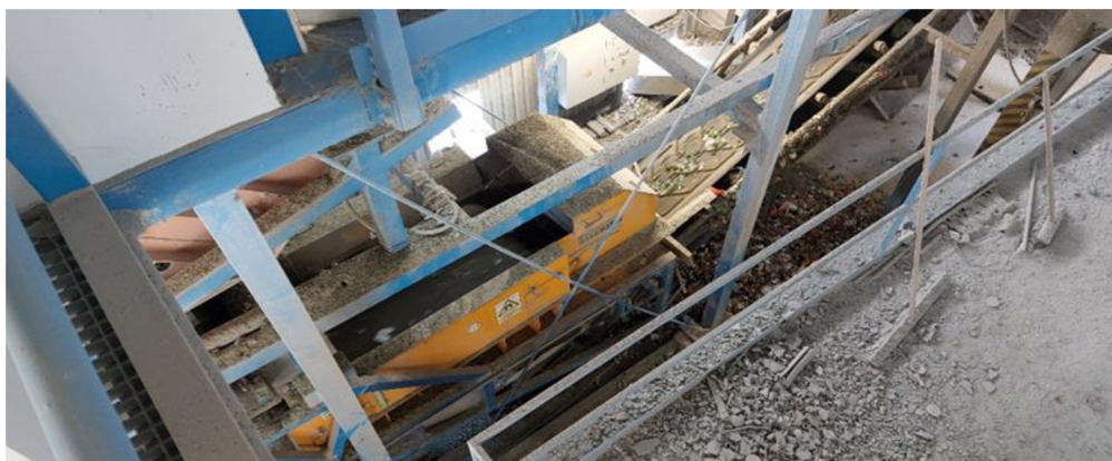
Obrázek 11: Drcení odpadu skla
