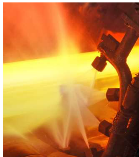
Obr. 17 Odstraňování okují vodním paprskem [27]
