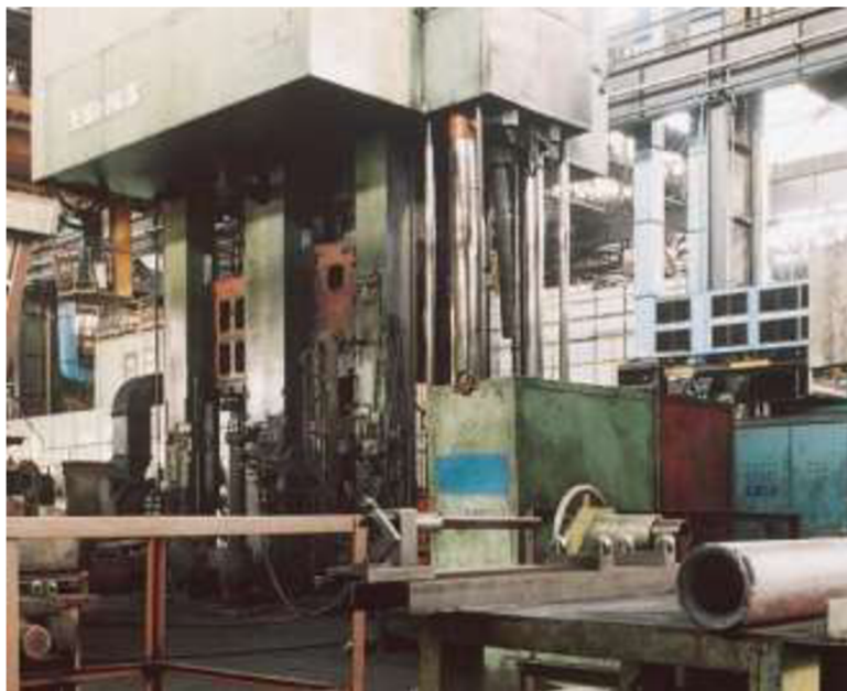
Obr. 36 Dvoupozicový hydraulický lis řady CKQ [35]
