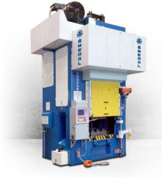
Obr. 25 Svislý kovací lis LZK 1600 P/SH [33]
