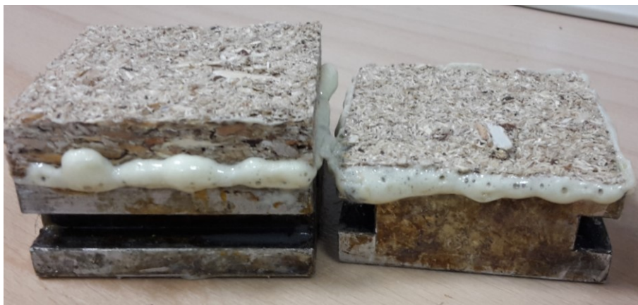
Obr. 23: Porušenie testovanej vzorky na rozlupčivosť v povrchovej vrstve (zdroj: vlastný)
