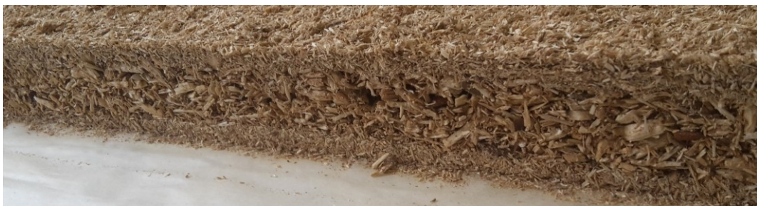
Obr. 13: Zhutnené vrstvy dosky pred vložením do lisu (zdroj: vlastný)
