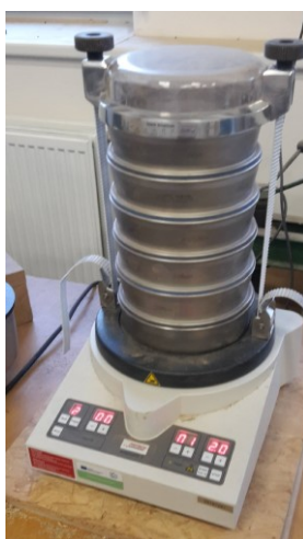
Obr. 10: Trojosí vibračný triedič FRITSCH analysette 3 (zdroj: vlastný)
