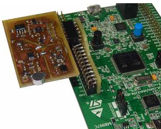
Obr. A.14: Připojení hlukoměrového čidla pomocí redukce
