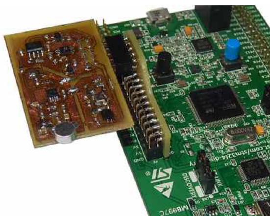
Obr. A.14: Připojení hlukoměrového čidla pomocí redukce
