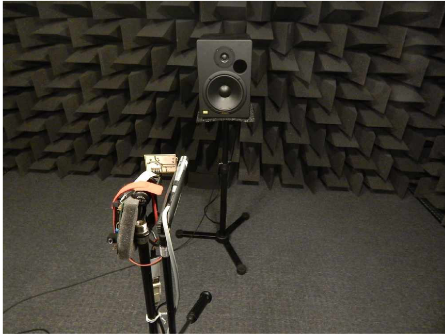
Obr. A.12: Měřící sestava v bezodrazové komoře (3)
