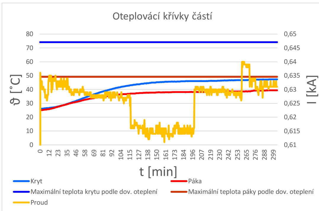
Obrázek 5-3 Oteplovací křivky částí jističe, zapojení č.1, měření č. 6
