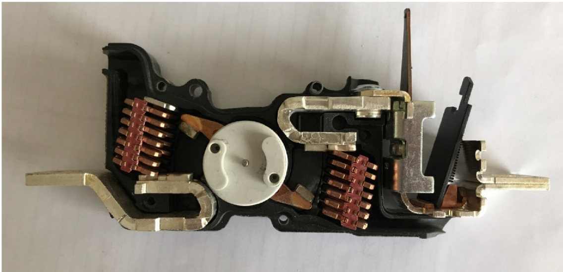
Obrázek 3-2 Rotační kontaktní systém
