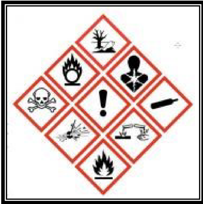
Obr. 2.1 Označovanie balení nebezpečného tovaru podľa tried rizika
