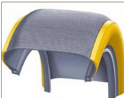
Obr. č. 9: Bočnice [5]
