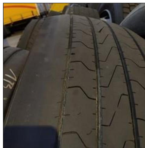
Obr. č. 19: Opotřebení v ramenní oblasti [vlastní]
