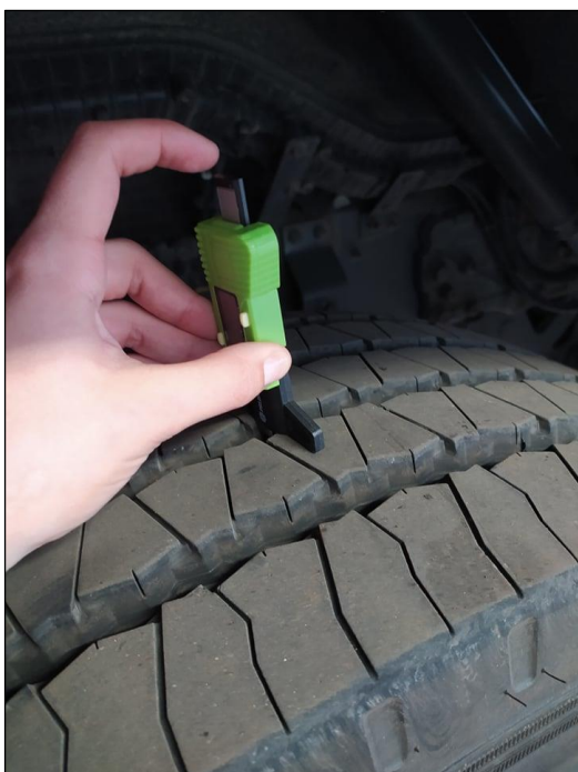
Obr. č. 54: Měření opotřebení pneumatiky [vlastní]
