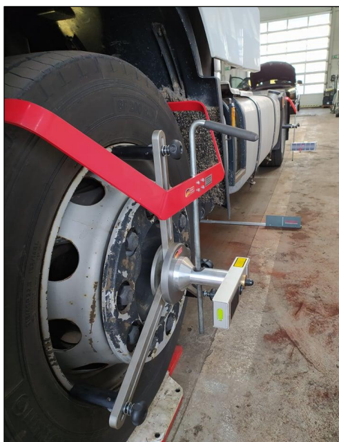
Obr. č. 26: Optické měřidlo KOCH-ACHSMESSANLAGEN HD-30 EasyTouch – zdroj světla [vlastní]
