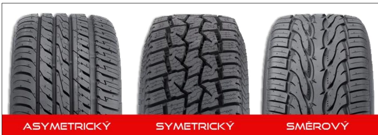
Obr. č. 11: Asymetrický, symetrický a směrový dezén pneumatiky [9]
