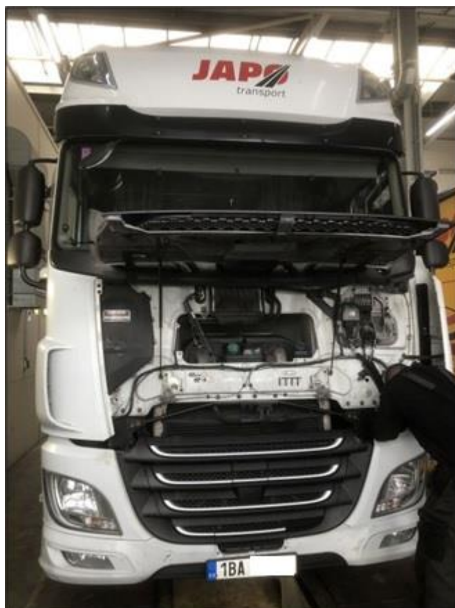
Obr. č. 49: Nastavování převodky řízení [vlastní]
