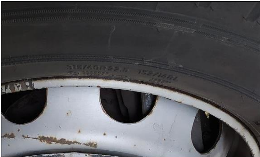
Obr. č. 13: Značení pneumatiky [vlastní]
