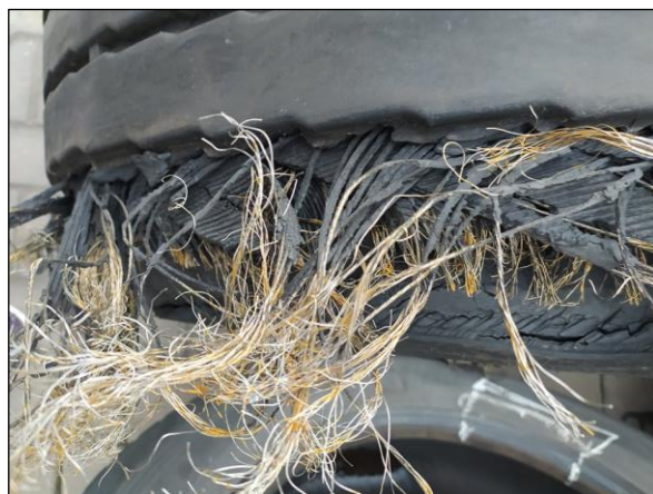
Obr. č. 5: Detail pogumovaných ocelových kordů [vlastní]
