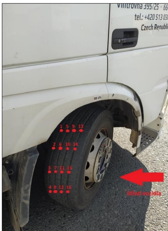
Obr. č. 56: Body měření opotřebení pneumatiky [vlastní]
