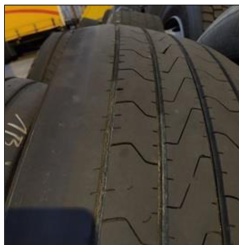
Obr. č. 19: Opotřebení v ramenní oblasti [vlastní]
