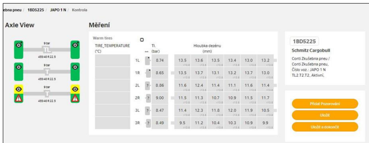
Obr. č. 53: Měření hloubky dezénu pneumatiky aplikací společnosti Continental [Aleš Langer]
