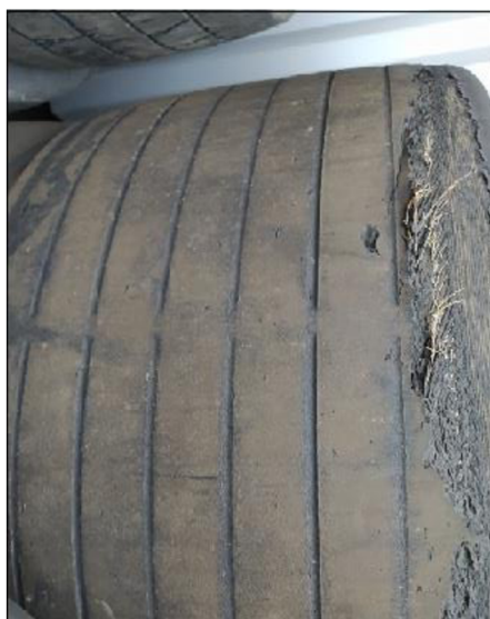
Obr. č. 15: Jednostranné opotřebení [vlastní]
