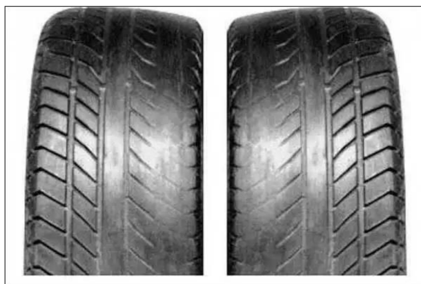
Obr. č. 14: Jednostranné opotřebenění [15]
