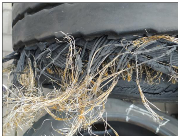
Obr. č. 5: Detail pogumovaných ocelových kordů [vlastní]
