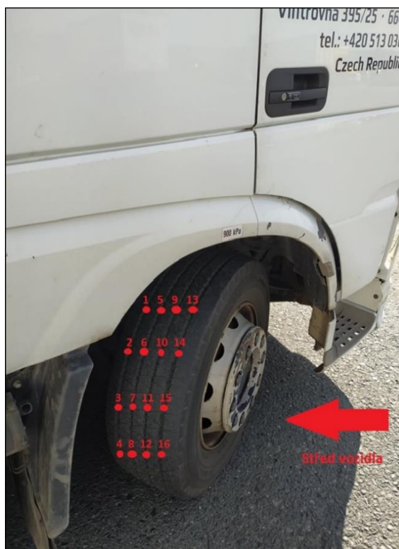
Obr. č. 56: Body měření opotřebení pneumatiky [vlastní]
