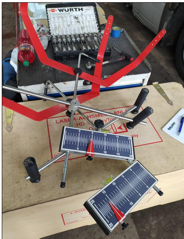
Obr. č. 43: Projekční plocha se stupnicí [vlastní]
