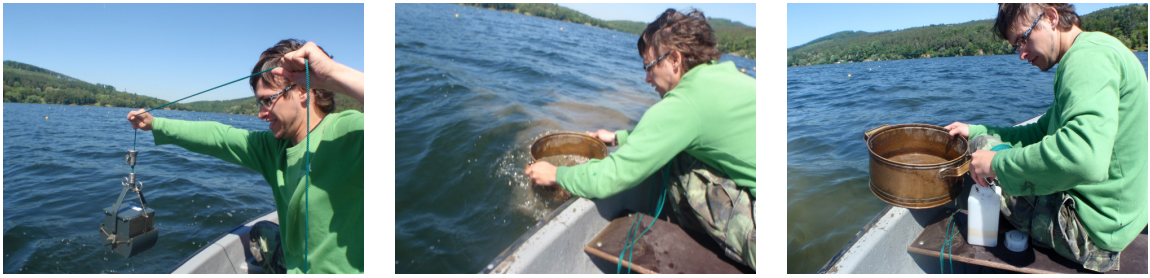
Obr. 14: Odběr sedimentů ze dna přehrady
