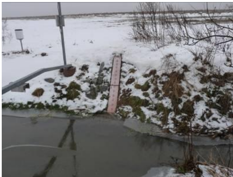
Příloha obr. 3 Měrný profil - detail měření vodního stavu (polohy hladiny)
