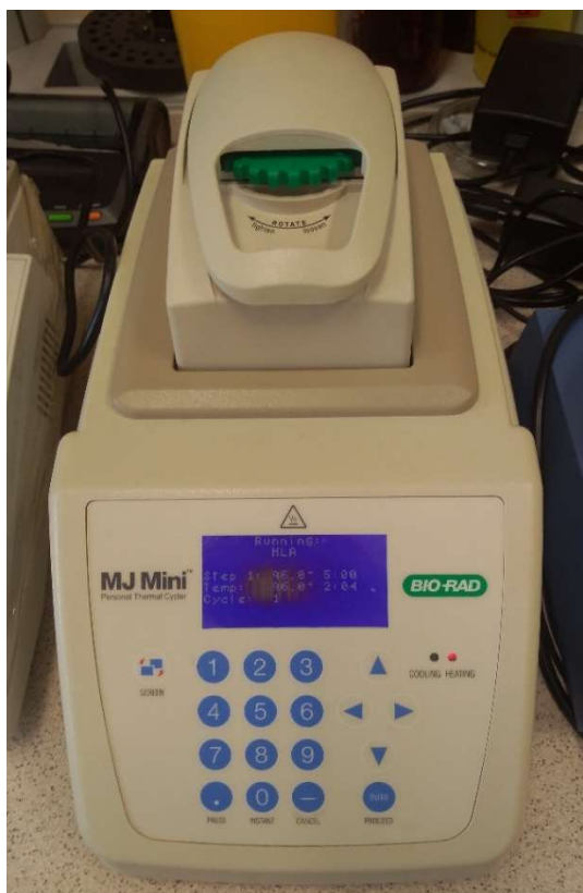
Obrázek 5 Termocyklér MJ Mini Bio-Rad, ve kterém probíhala amplifikace PCR produktů podle nastaveného programu.
