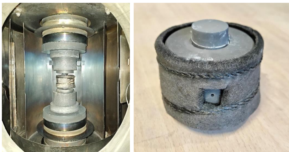
Obr. 21 Slinovací zařízení SPS: vlevo uložení formy v komoře (kap. 3.3.1); vpravo detail na slepý otvor ve formě sloužící k měření teploty
