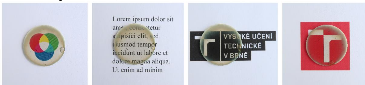
C6_25_NoLi: MgAl 2 O 4 (S25CR), SPS T max = 1350 °C, t = 0,8 mm, ø = 20 mm
