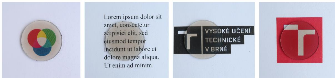
C6_25_06Li: MgAl 2 O 4 (S25CR) + 0,6 hm. % LiOH, SPS T max = 1350 °C, t = 0,8 mm, ø = 20 mm
