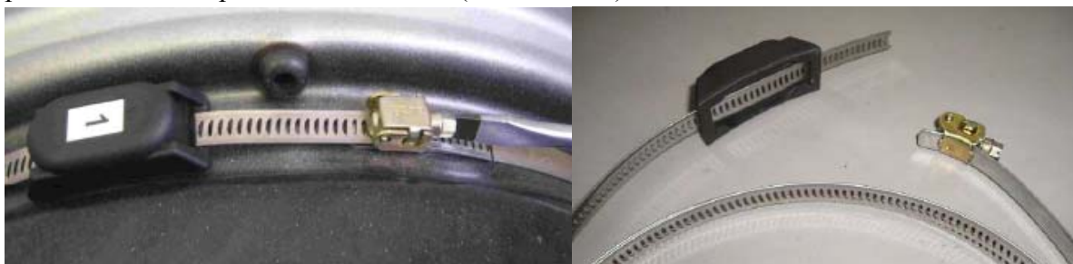
Obr. 8.13 Připevnění senzoru pomocí upínací pásky
