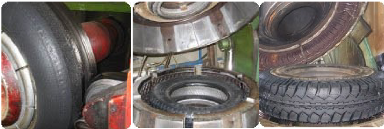
Obr. 6.10 Výroba protektoru „za tepla“
