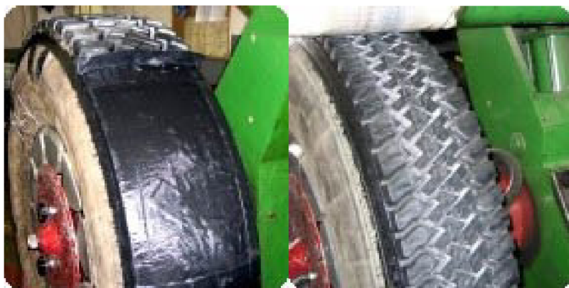
Obr. 6.11 Výroba pláště „za studena“
