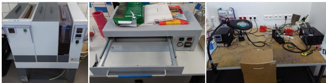
Obr. 4.2: Leptací lázeň, osvětlovací zařízení a pájecí pracoviště
