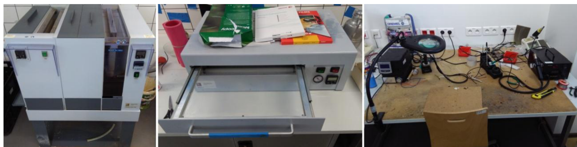
Obr. 4.2: Leptací lázeň, osvětlovací zařízení a pájecí pracoviště
