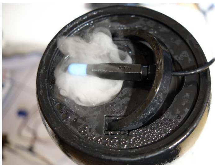
Obrázek 17 Testování senzoru – měření vlhkosti v laboratorních podmínkách externí sondou
