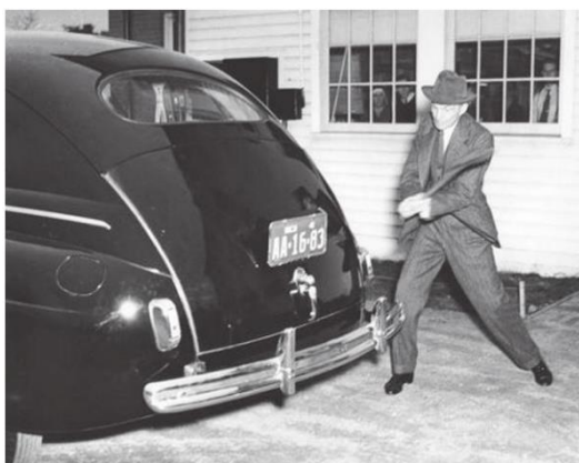
Obrázek 1.44: Henry Ford zkouší v roce 1940 pevnost dílů karoserie vyztužených přírodními vlákny (Baltazar & Sain, 2012)
