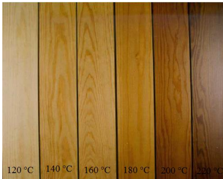
Obr. 11 - Barva tepelně upraveného dřeva borovice (ThthermoWood Handbook 2003)
