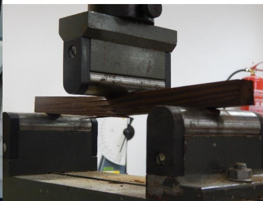
Obr. 25 – Zatěžování ohybem – 3. stupeň
