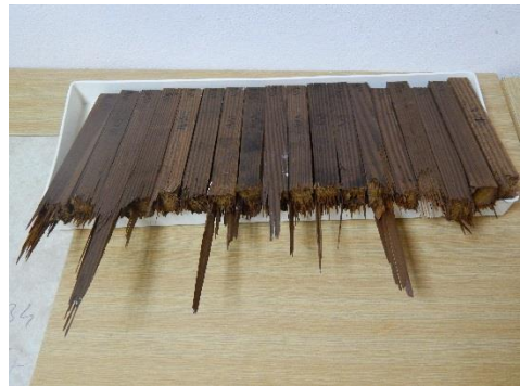
Obr. 21 - Vzorky upravené při 210 °C po vykonání zkoušky rázové houževnatosti
