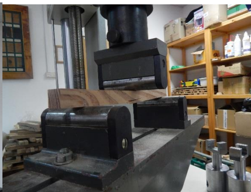
Obr. 24 – Zatěžování ohybem – 2. stupeň
