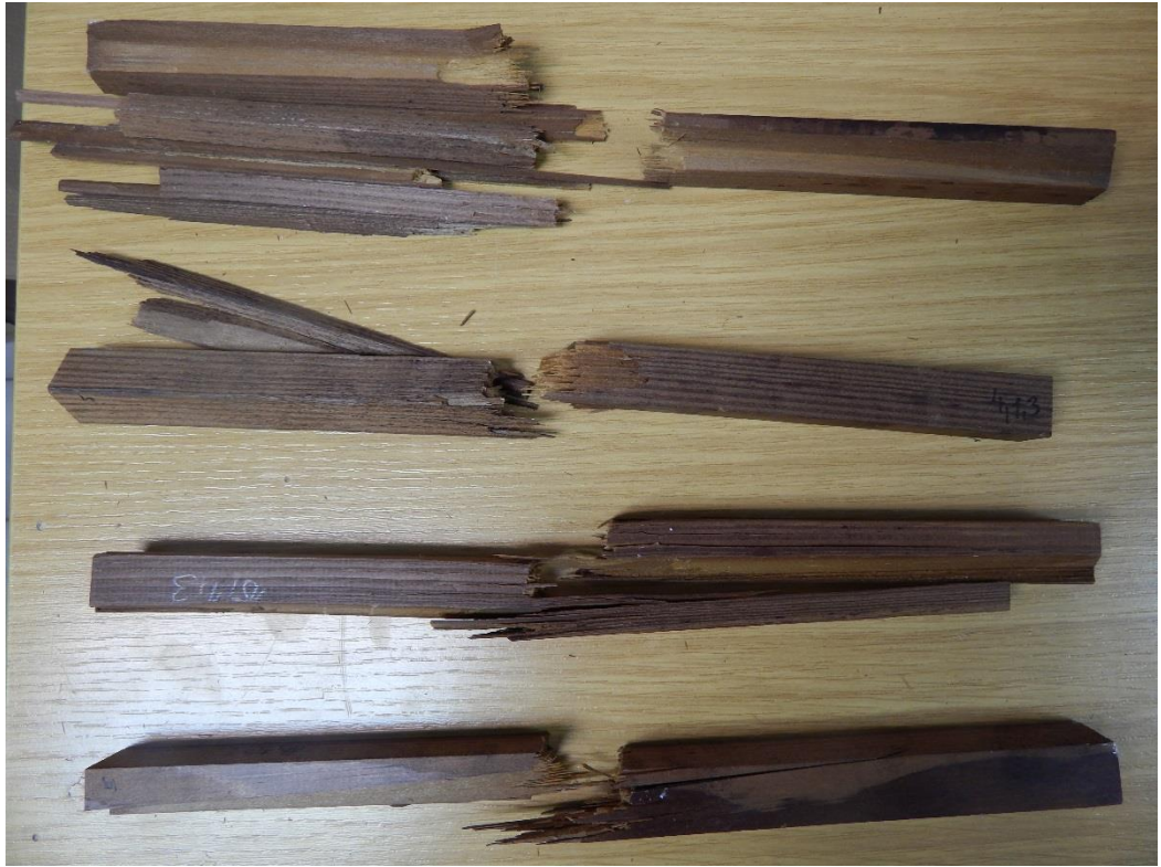
Příloha 3 - Některé vzorky s úpravou při 210 °C po vykonání zkoušky na ráz
