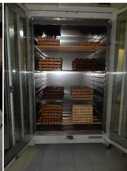
Obr. 18 - Klimatizování vzorků po termické úpravě
