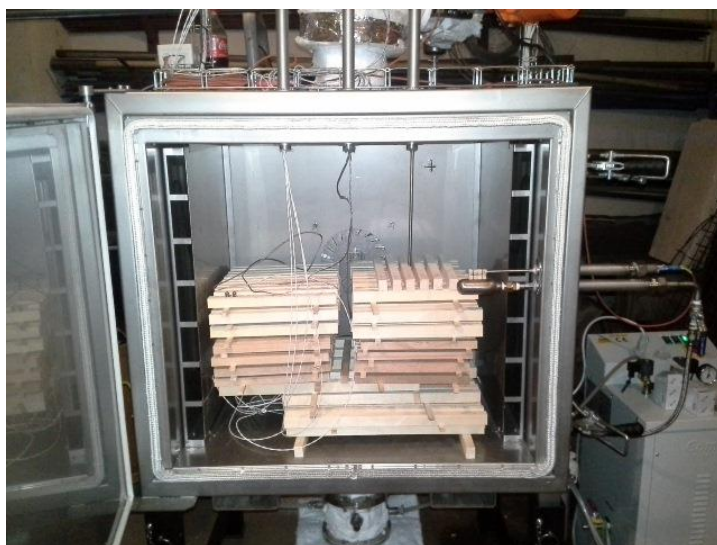
Obr. 17 - Uložení vzorků v termokomoře
