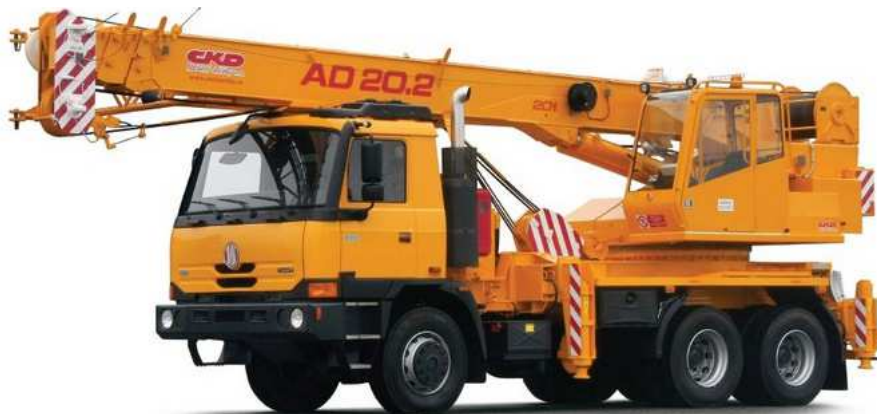
Obr. 3.12 – Autojeřáb Tatra AD-20
