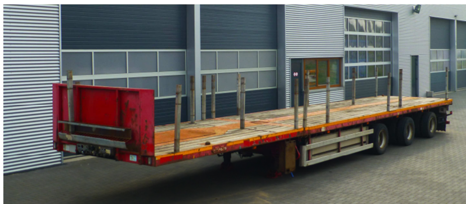
Obr. 3.2 –Návěs Nootboom OVB-48-03V v zatažené poloze
