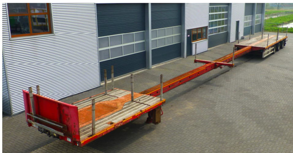
Obr. 3.5 –Návěs Nootboom OVB-48-03V vytažený do druhé polohy
