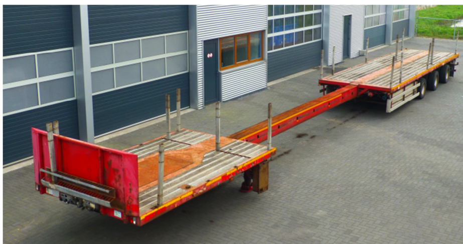
Obr. 3.3 –Návěs Nootboom OVB-48-03V vytažený do první polohy
