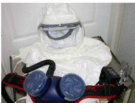
Obr. 9: Filtro-ventilační jednotka JUPITER 3M vytvářející přetlak v náhlavním díle s filtry P3 (včetně baterie pro provoz na cca 8h)
