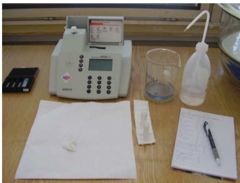
Obr.č.6: Spektrofotometr pro mobilní analýzu.
