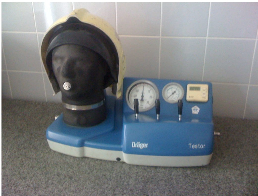
Obr. 7: měřicí přístroj pro podtlakovou kontrolu masky a vrapové hadice - HZS Česká Lípa
