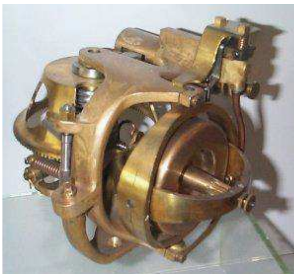
Obr. 1.3: Řídicí mechanismus torpéda [4].
