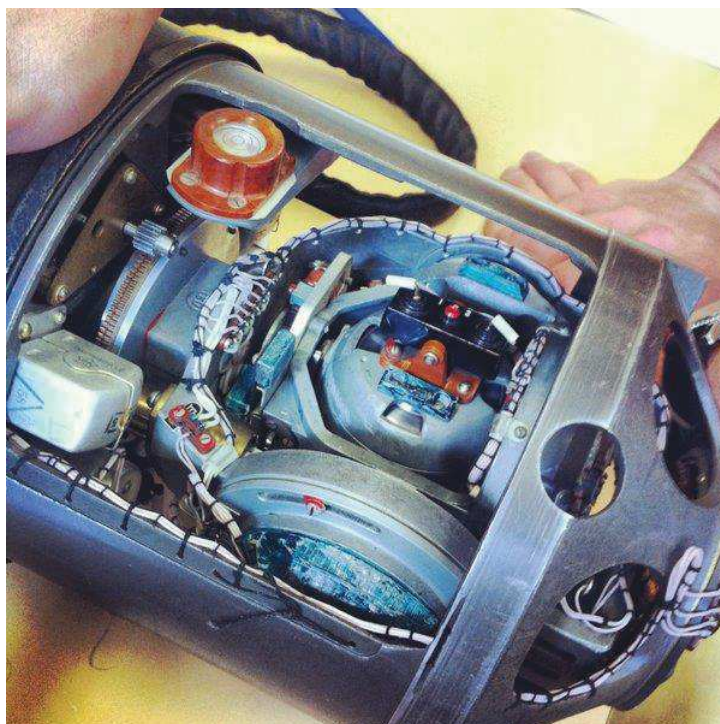
Obr. 1.9: Detail útrob umělého horizontu [15].
