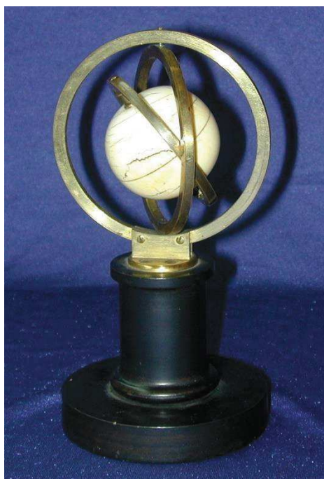
Obr. 1.2: Model von Bohnenbergerova gyroskopu [4].
