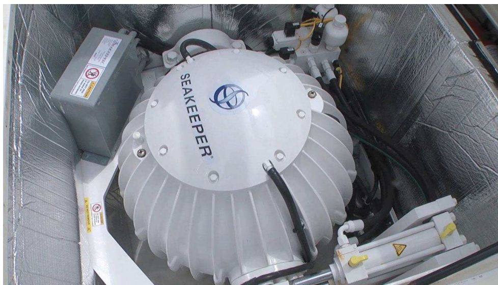
Obr. 1.14: Detail lodního stabilizátoru firmy Seakeeper [19].
