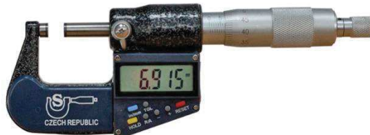
Obr. 1.2: Digitální mikrometr SCHUT
