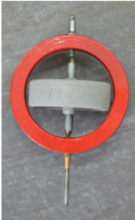
Obr. 1.1: Autorem sestrojený dřevěný gyroskop
