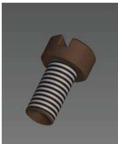
Obr. 2.9. Detail ložiskového šroubu gyroskopu.
