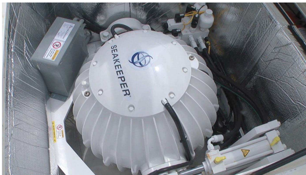
Obr. 1.14: Detail lodního stabilizátoru firmy Seakeeper [19].
