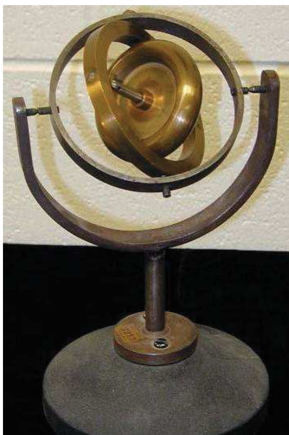
Obr. 1.6: Gyroskop klasické konstrukce uložený v Cardanově závěsu [4].
