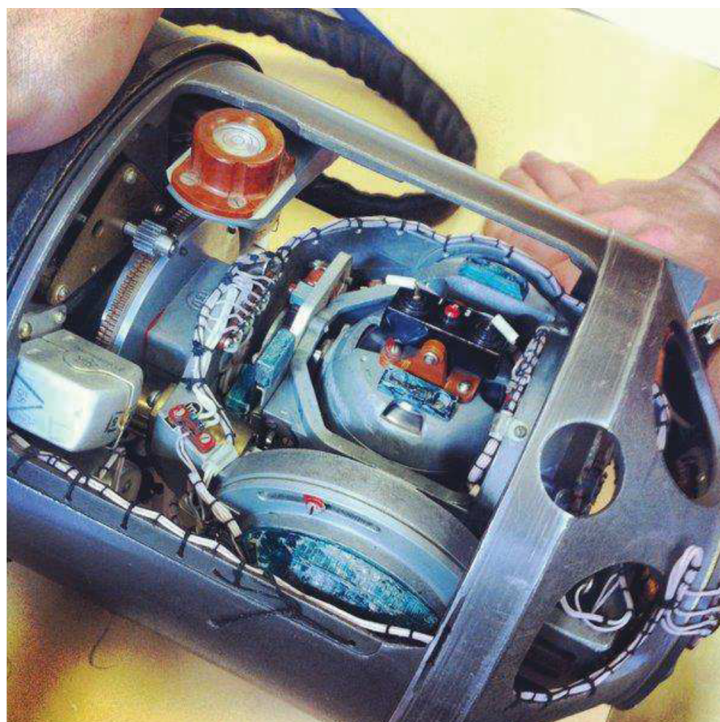
Obr. 1.9: Detail útrobu umělého horizontu [15].
