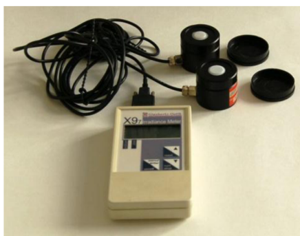
Obr. 19 Radiometr obsahující sondy pro UV a pro VIS oblast spektra
