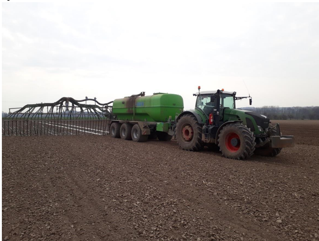
Obr. 3 Aplikace kejdy pomocí cisterny BAUER o objemu 24 000 l s hadicovým aplikátorem se záběrem 18 m
