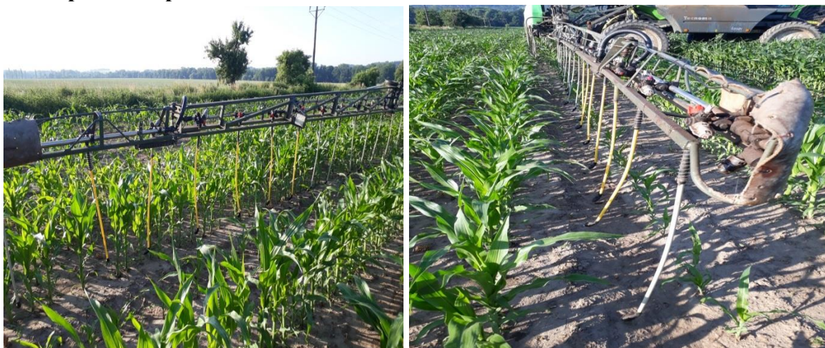
Obr. 4 Aplikace hnojiva DAM 390 pomocí samohodného postřikovače Tecnomas Laser 3240 s použitím speciálních nástavců
