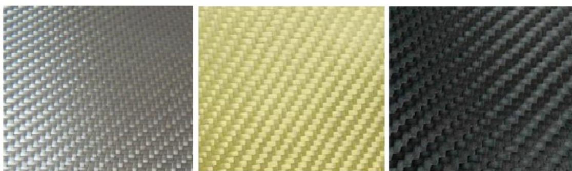
Obr. 2.2: Vláknenná výztuž ve formě rovingu zleva: sklená vlákna, aramidová vlákna a uhlíková vlákna [10, 11, 12]
