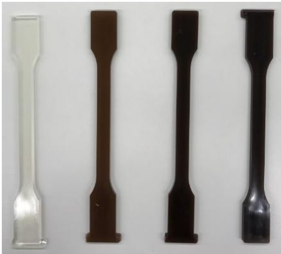
Obr. 3.3: Vzorky typu 1A dle normy ISO 527, zleva: hm. obsah L-CNC 0%, 1%, 2% a 3%
