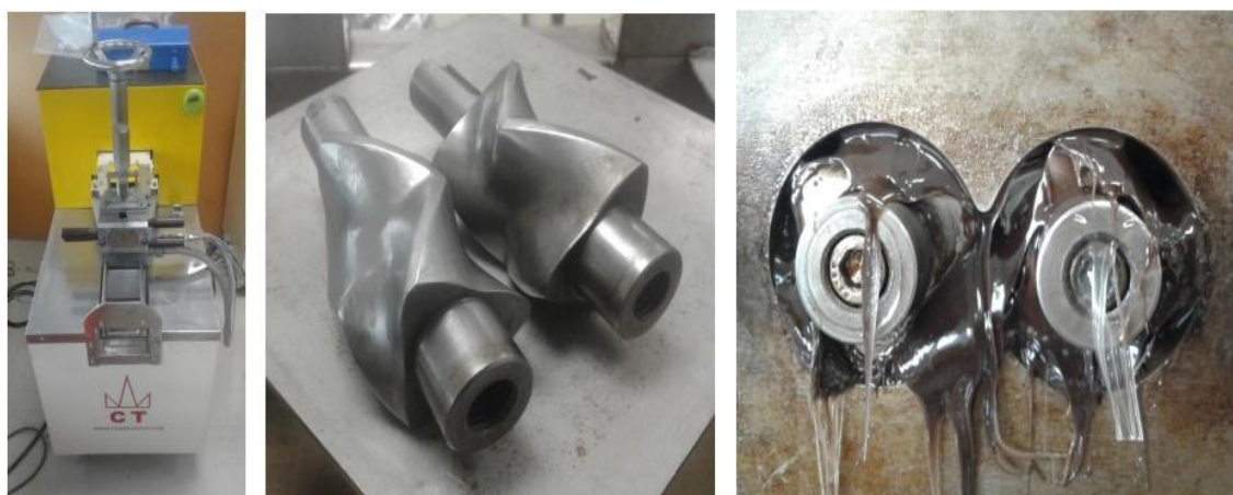
Obr. 3.3: Hnětací zařízení pro přípravu masterbatche – zleva: hnětič, míchací elementy, detail otevřené míchací komory po disperzi L-CNC v PLA matrici
