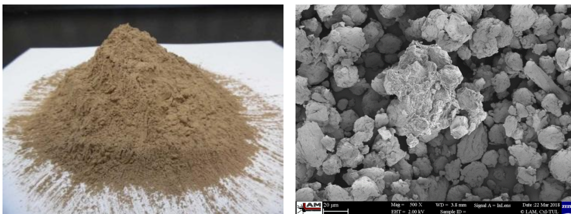
Obr. 3.1: Nanokrystaly celulózy povrchově upravené ligninem vlevo: sprejově vysušený prášek, vpravo: SEM snímek nanokrystalů (L-CNC)
