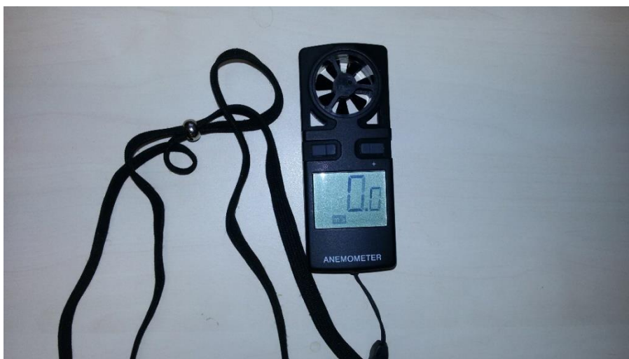
Obrázek 14 – Anemometr Techno Line EA3000, zdroj: autor
