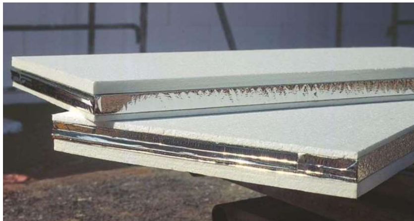
Obrázek 21: Sendvičový panel (polystyrén + VIP) [8]
