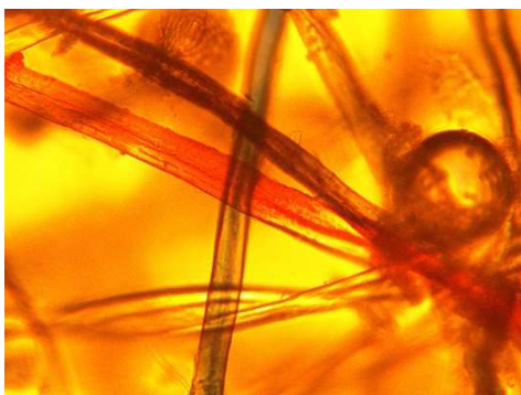
Obrázek 34: Bavlněné vlákno při 40tinásobném zvětšení
