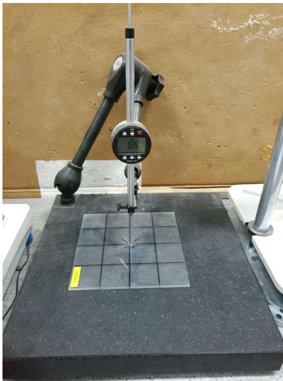
Obrázek 31: Příklad pro stanovení tloušťky zkušebních vzorků
