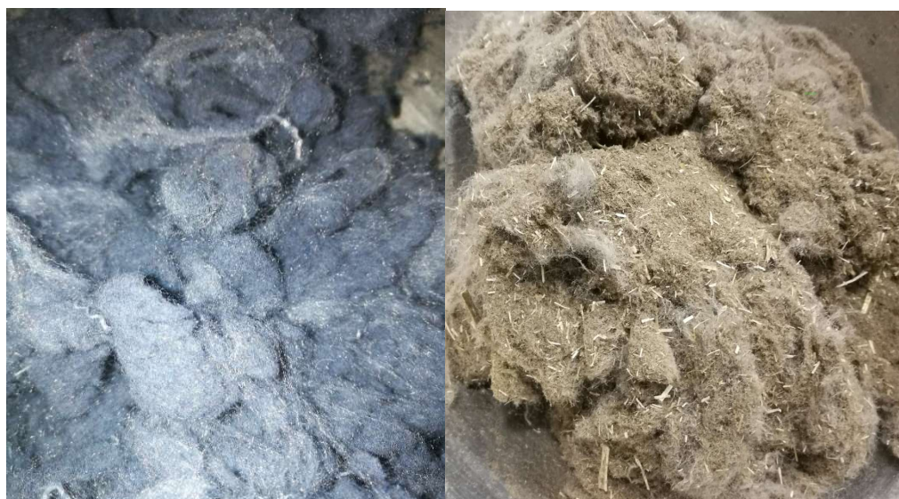
Obrázek 24: Směsi z odpadu ze zpracování bavlny a lnu pojené bikomponentním vláknem
