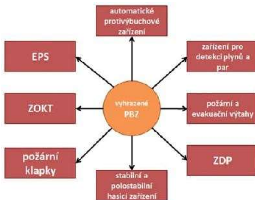
Obr. č. 4: Diagram vyhrazených požárně bezpečnostních zařízení 6
