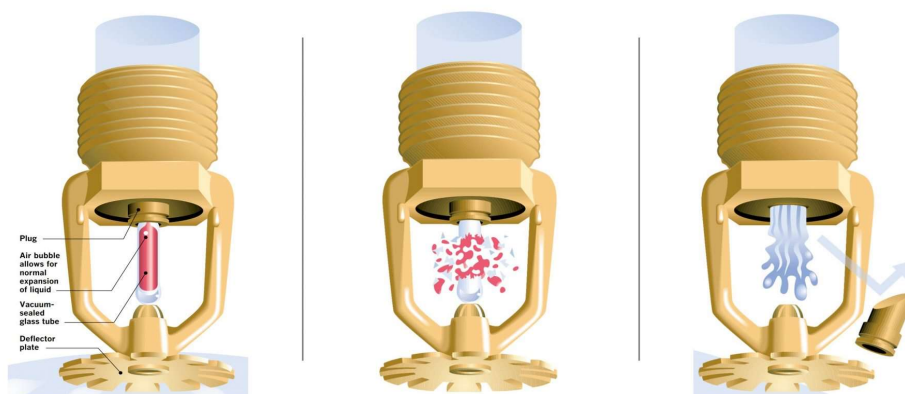
Obr. č. 9: Aktivace sprinklerové hlavice 10
