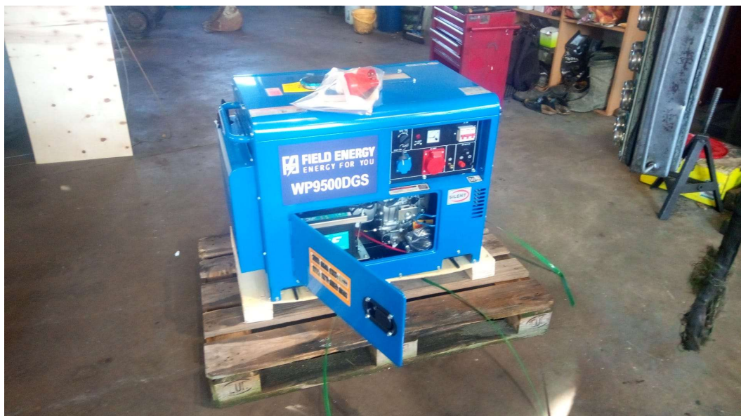
Obr. č. 17: Dieselagregát – zdroj: vlastní foto
