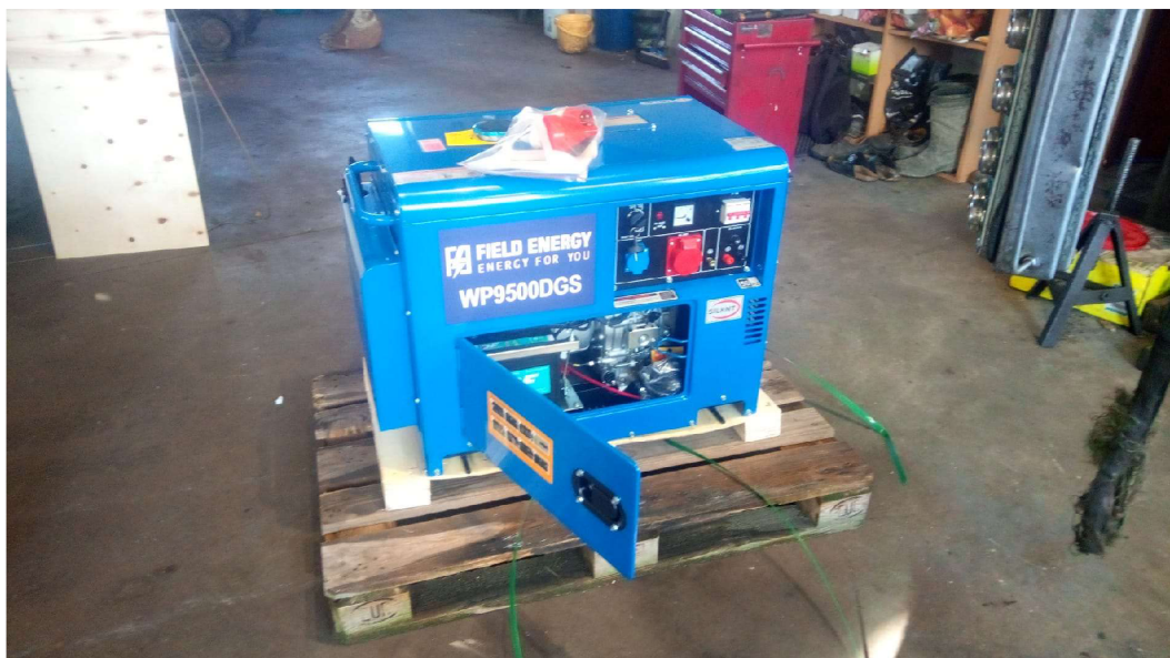
Obr. č. 17: Dieselagregát – zdroj: vlastní foto
