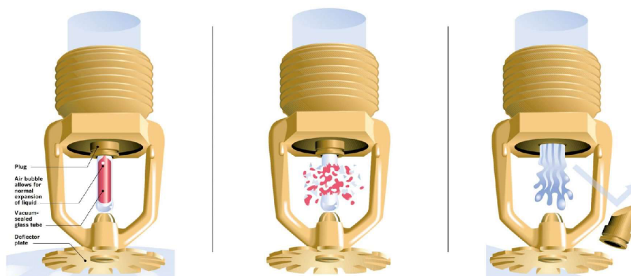
Obr. č. 9: Aktivace sprinklerové hlavice 10
