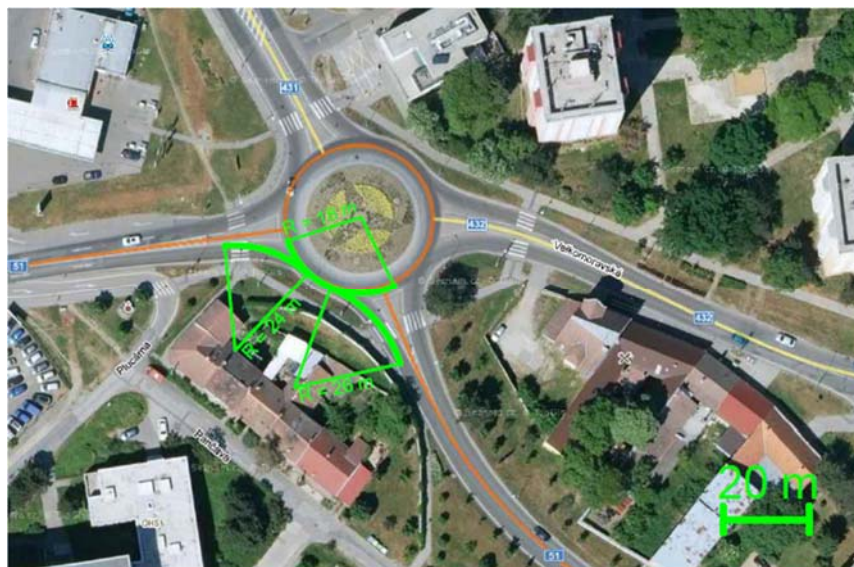
Obr. 2.8.7 Trasa dopravy věžového jeřábu – zájmový bod 33 – 4,9 km [3]
