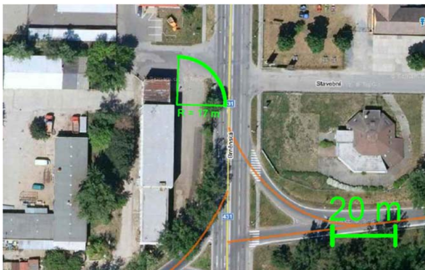
Obr. 2.8.2 Trasa dopravy věžového jeřábu – zájmový bod 28 – 0,1 km [3]
