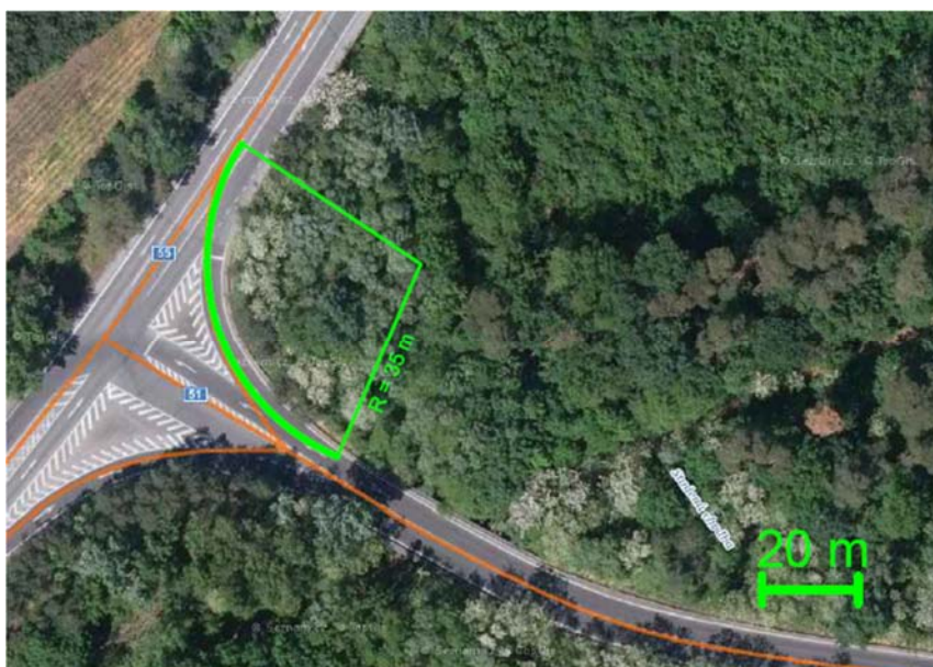
Obr. 2.8.3 Trasa dopravy věžového jeřábu – zájmový bod 29 – 2,9 km [3]
