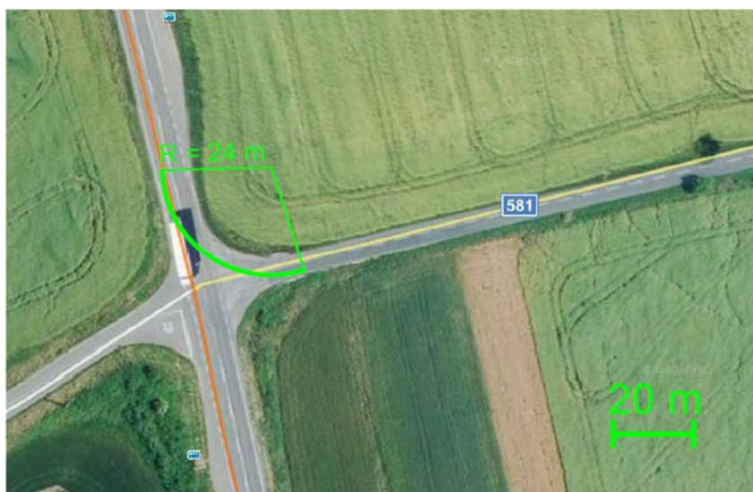
Obr. 2.8.10 Trasa dopravy věžového jeřábu – zájmový bod 36 – 28,1 km [3]
