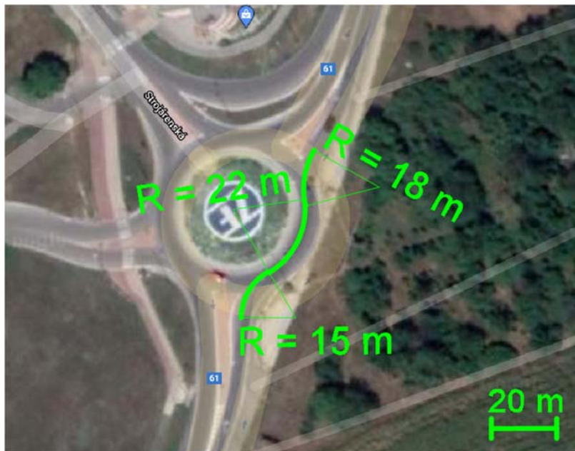
Obr. 2.4.3 Trasa dopravy oceli – zájmový bod 6 – 8,5 km [3]
