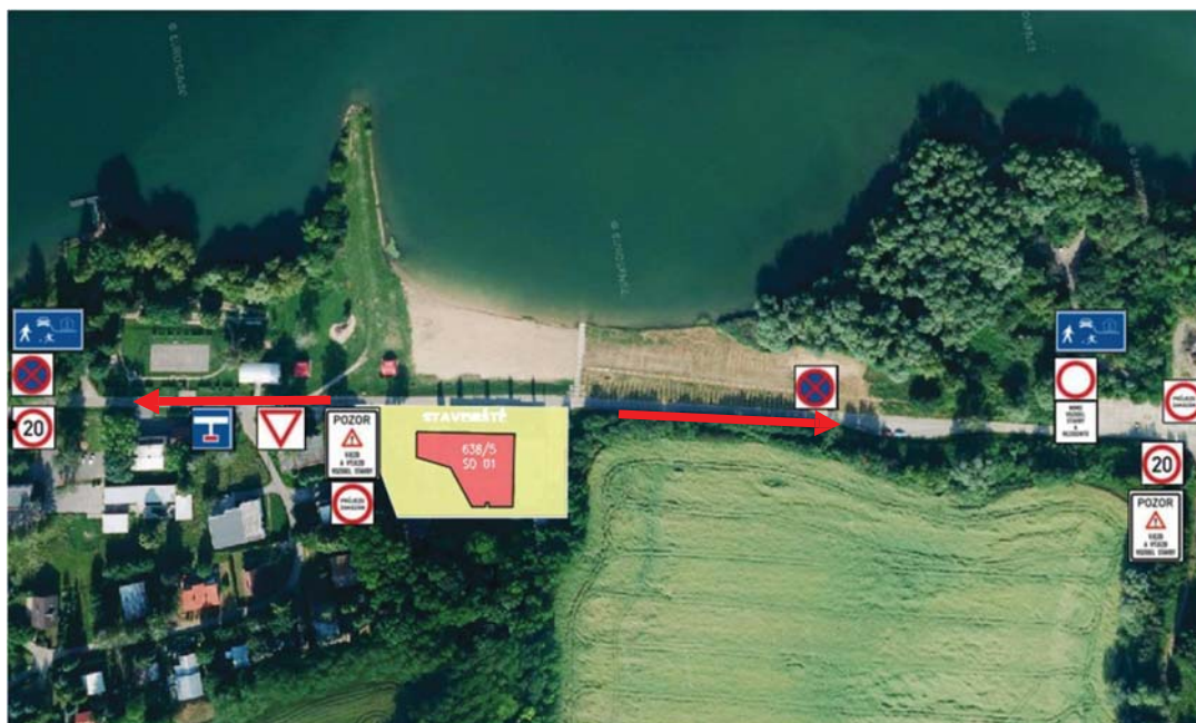
Obr. 6.1.2 Dopravní značení stavby [3]
