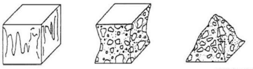
Obr. 10.3.1 Vyhovující tvar betonového vzorku po zkoušce pevnosti v lisu
