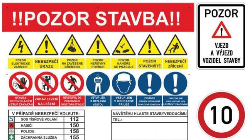
Obr. 6.2.1 Značení upozorňující na rizika na staveništi [4]
