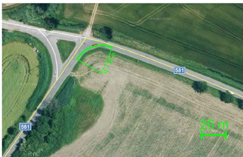
Obr. 2.8.11 Trasa dopravy věžového jeřábu – zájmový bod 37 – 28,9 km [3]
