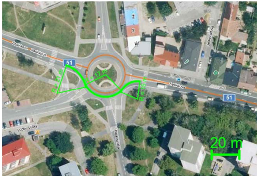
Obr. 2.8.8 Trasa dopravy věžového jeřábu – zájmový bod 34 – 10,0 km [3]
