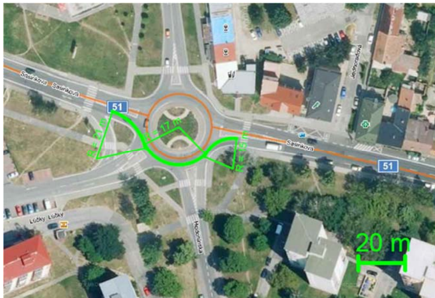
Obr. 2.8.9 Trasa dopravy věžového jeřábu – zájmový bod 35 – 10,5 km [3]
