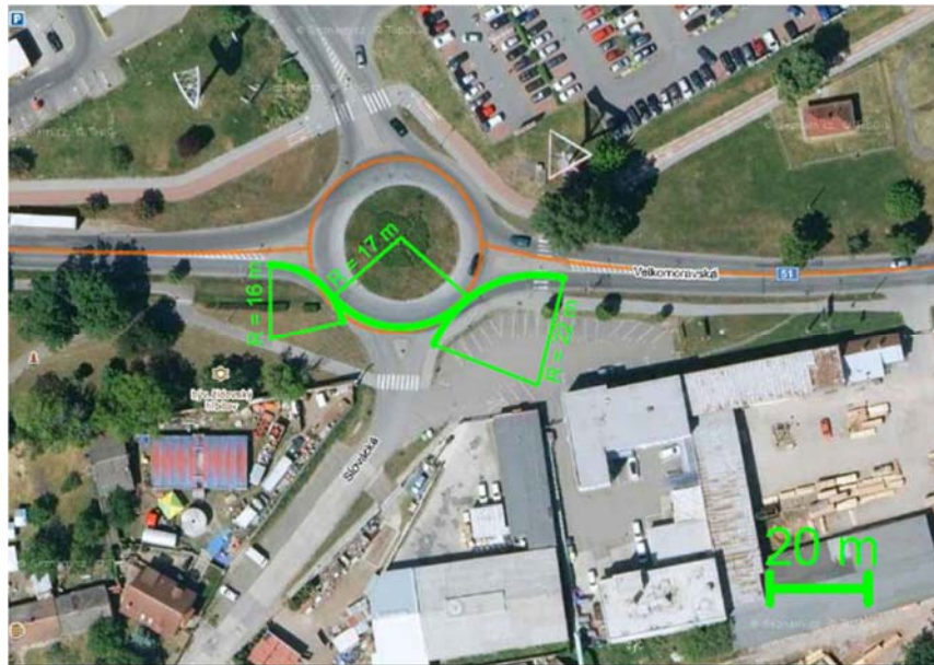
Obr. 2.8.6 Trasa dopravy věžového jeřábu – zájmový bod 32 – 4,7 km [3]
