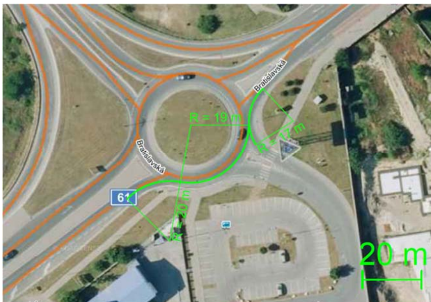
Obr. 2.5.11 Trasa dopravy systémového bednění – zájmový bod 22 – 20,2 km [3]
