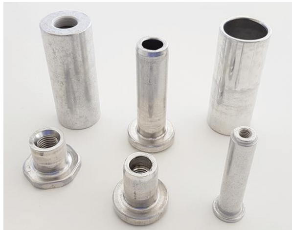
Obr. 27 Příklady sdružených protlačků [22].
