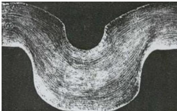
Obr. 12 Deformační struktura kovu [12]. Obr. 13 Vlákna obrábění X tváření [13].
