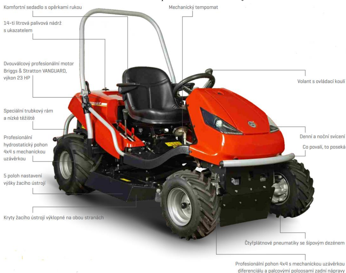
Obr. 19: Popis hlavních částí Crossjet
