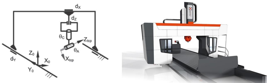
Obr. 22 Kinematická schéma portálového obrábacieho stroja [TOS Kuřim]
