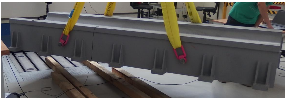
Obr. 79 Lôžko stroja FUT pod stojan, bez betónovej výplne [TOS Kuřim, Intemac Solutions]
