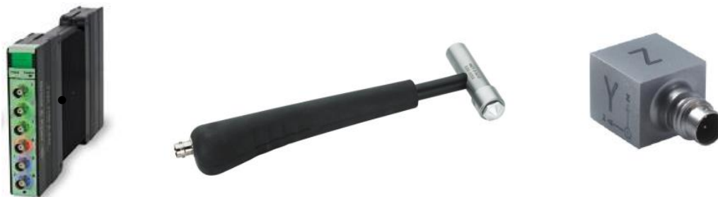
Obr. 78 Analyzátor (vľavo), modálne kladivko (uprostred), akcelerometer (vpravo) [Brüel & Kjaer]
