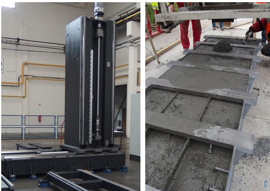
Obr. 77 Montáž stroja FUT (vľavo), výroba kompozitného dielu lôžka FUT (vpravo) [TOS Kuřim]
