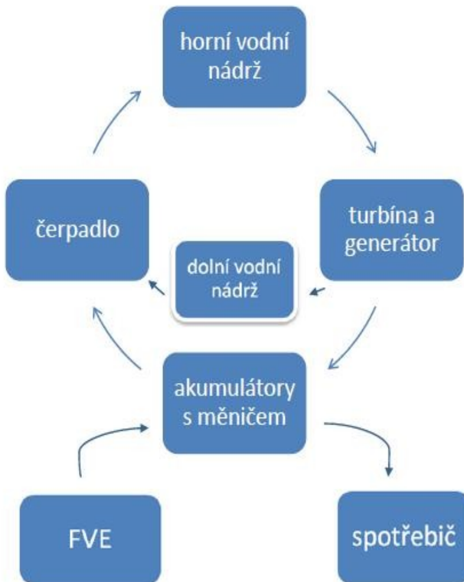
Obrázek č. 14 Akumulace pomocí kombinace zásobníku vody a akumulátorů Zdroj: (Dvořáková, 2012)
