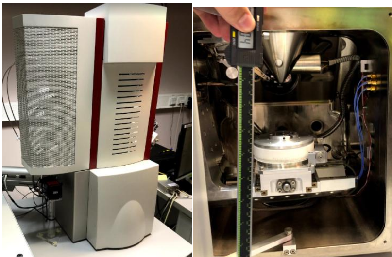
Obr. 3.3 Komora elektronového mikroskopu
