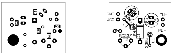
Obrázok 54: Osadenie PCB modulu ovládania podsvietenia displeja, strana spojov a strana súčiastok, 30,5 x 25,1 mm, M 1:1
