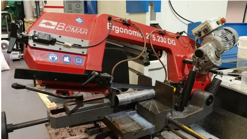
Obr. 21 Podélné rozříznutí trubky pásovou pilou
