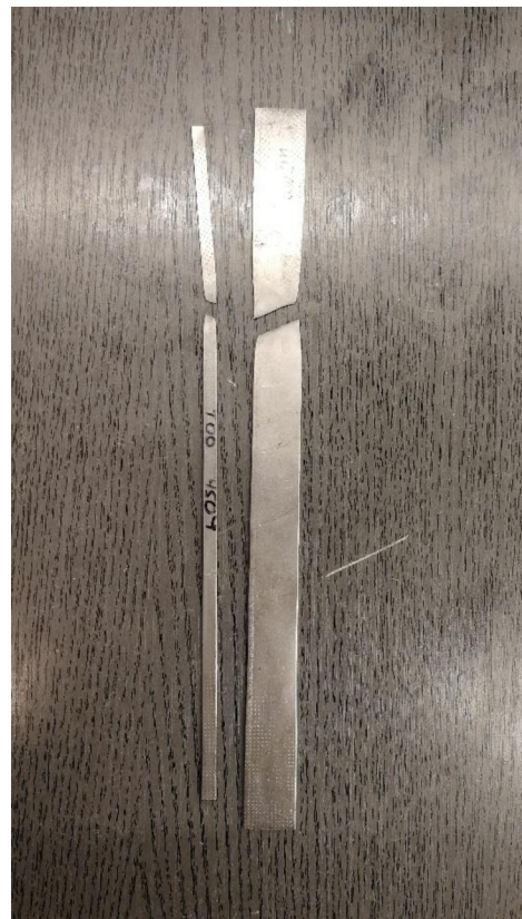
Obr. 29 Přetržený zkušební vzorek
