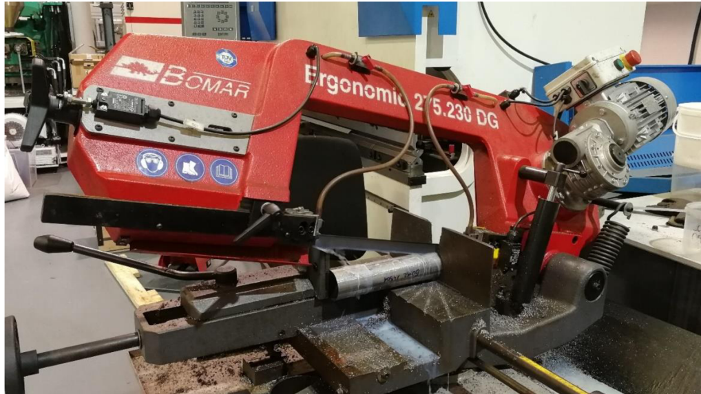
Obr. 21 Podélné rozříznutí trubky pásovou pilou
